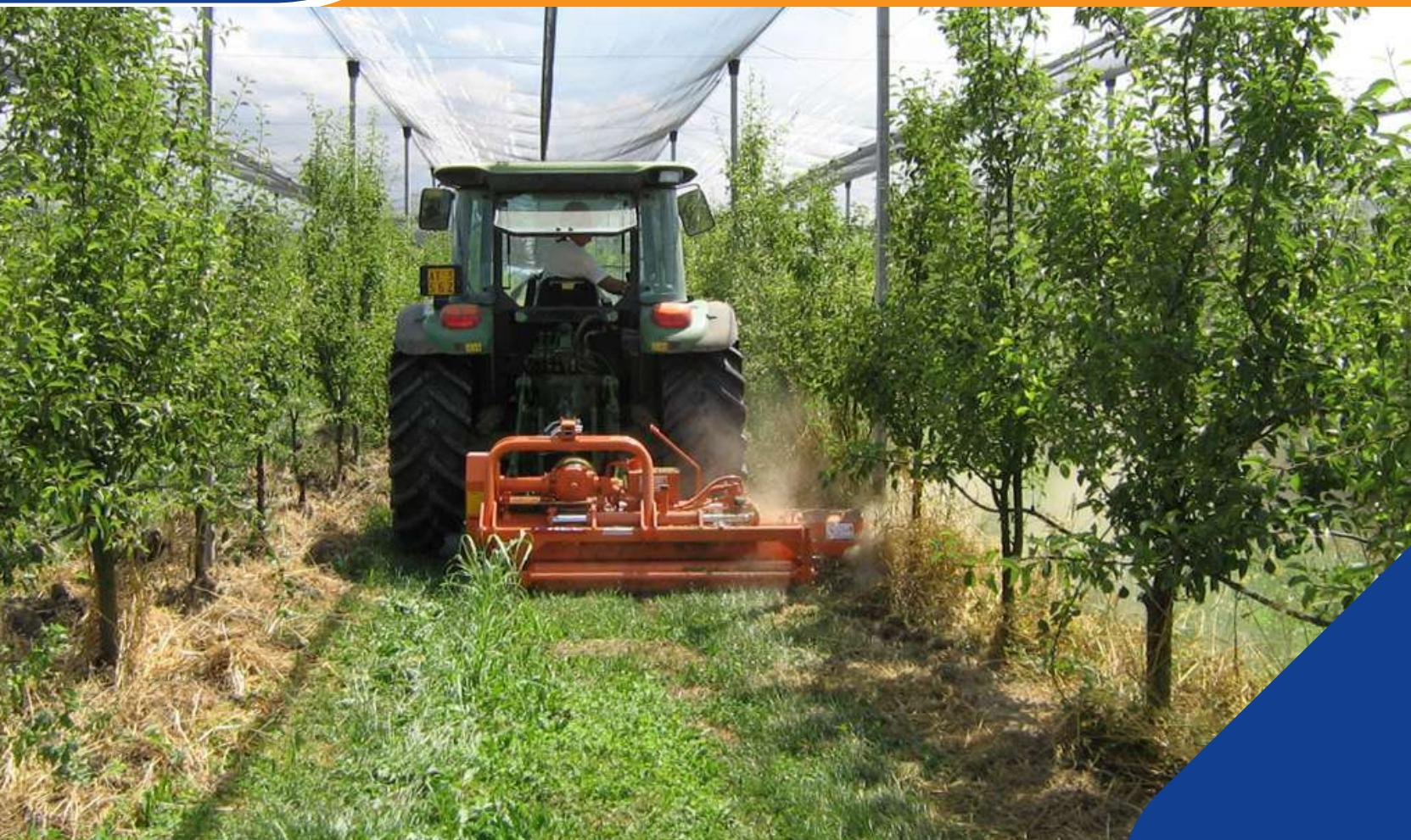
Trinciatrice interfilare a spostamento idraulico automatico per lavorazioni in frutteti e vigneti. Abbinabile anteriormente e posteriormente a trattori da 40 a 90 HP
