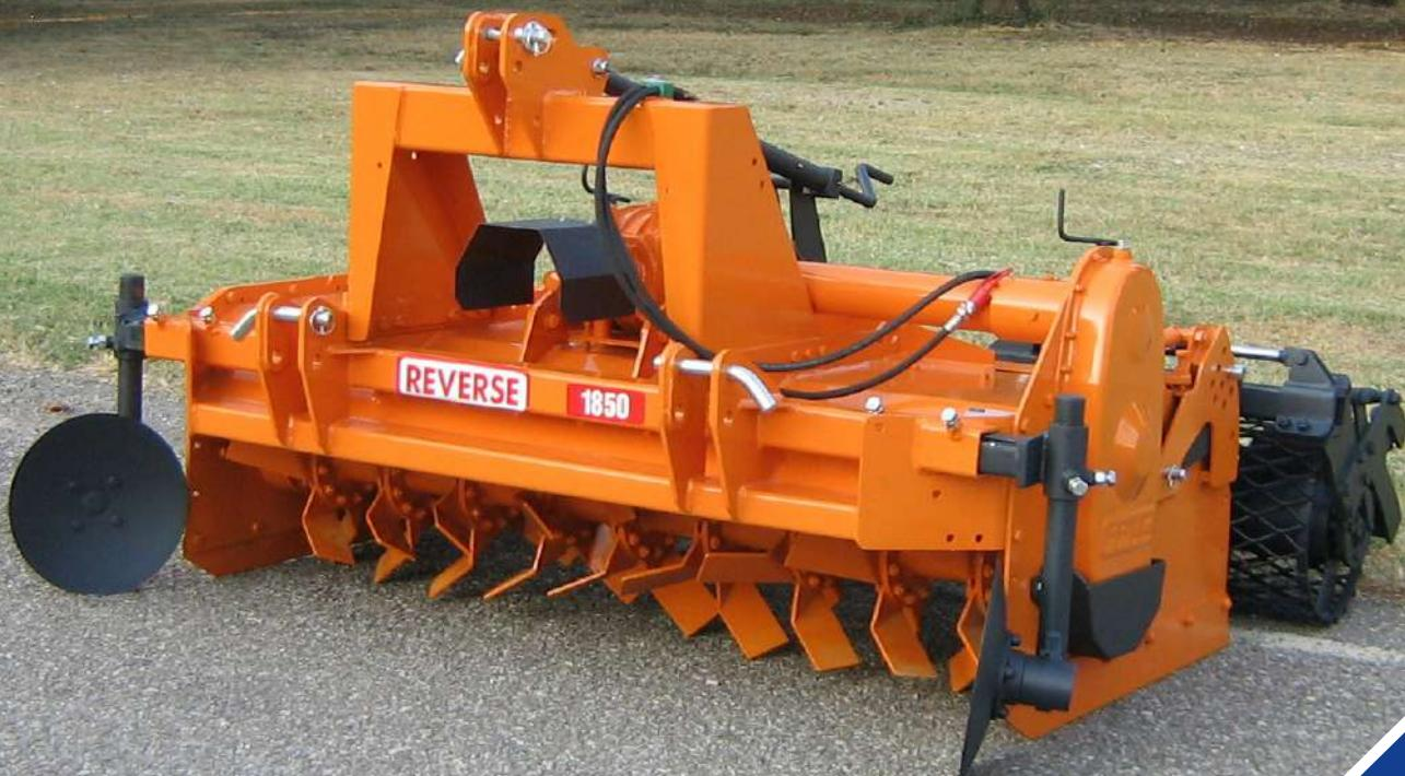
Fresatrice interrasassi ideale per la preparazione del letto di semina su qualsiasi tipo di terreno, sia con presenza di sassi che di residui culturali, nonché in presenza di terreno tenace ed argilloso.
